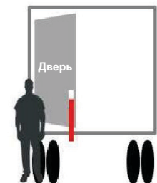
Снять ремень с двери 1. Открыть дверь, потянув на себя, таким образом, чтобы она оставалась между вами и грузовиком. Снять ремень.
